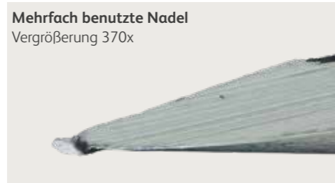
Fotografien von Nadelschäden, die bei Mehrfachverwendung auftreten können. D. Look und K. Strauss: „Nadeln mehrfach verwenden?“ Diabetes Journal 1998, 10: S. 31-34
